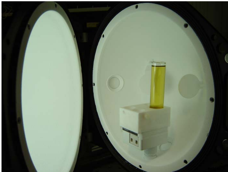
Figura 7. Particolare della sfera integratrice che mostra al suo interno un campione di olio di oliva.
