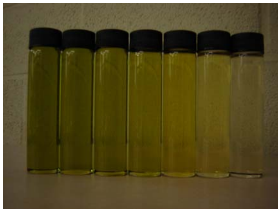
Figura 8. Vista della serie O3F2, come esempio delle variazioni di colore dei campioni di EVOO con differenti concentrazioni di olio frodante.
