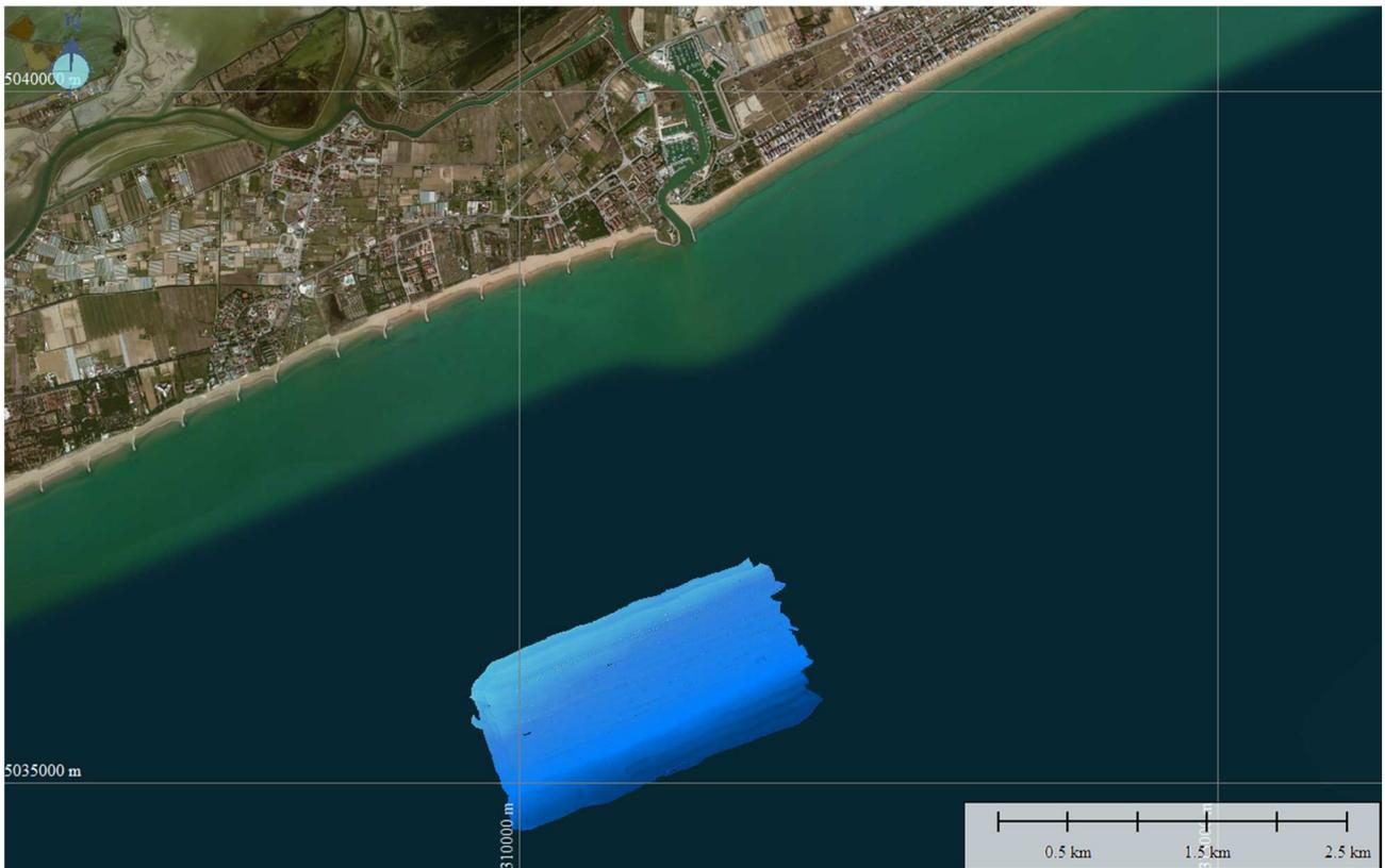
Fig. 6 – Area acquisita con il Reson Seabat 8125. In visualizzazione il DTM di acquisizione con cella di 1 x 1 m; proiezione WGS84 UTM 33.
