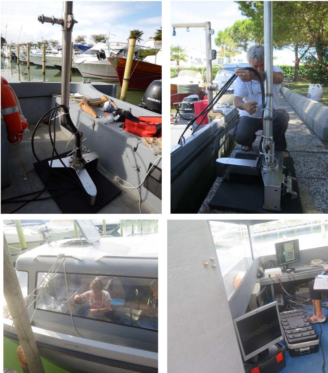
Fig. 3 – Operazione di installazione della strumentazione. In alto il multibeam montato a palo e successivamente posizionato lateralmente alla murata dell'imbarcazione, in basso il montaggio della stazione operativa.
