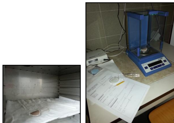
Figura 8. Da sinistra: filtro in stufa e successiva misurazione del peso in bilancia
