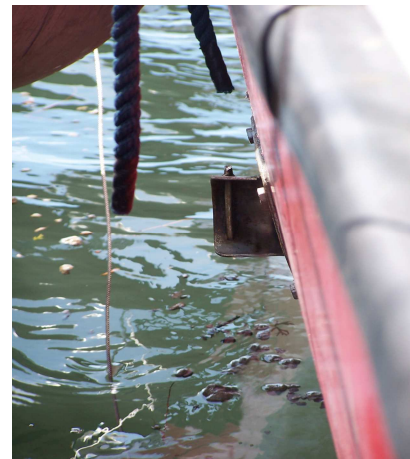
Visualizzazione frontale della controstaffa (in alto) e laterale (a destra)
