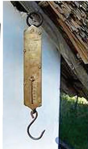
Figura 1.10 – Dinamometro: misuratore di forza di trazione e di forza-peso. Da [106].
