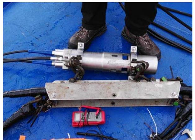
**Fig. 4.** Particolari delle sorgenti sismiche utilizzate (GI-gun Sodera 4,1 L e mini GI-gun Sodera 0,1 L)
