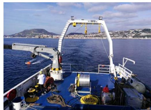
**Fig. 1.** N/O Minerva e particolare delle operazioni di acquisizione sismica.
