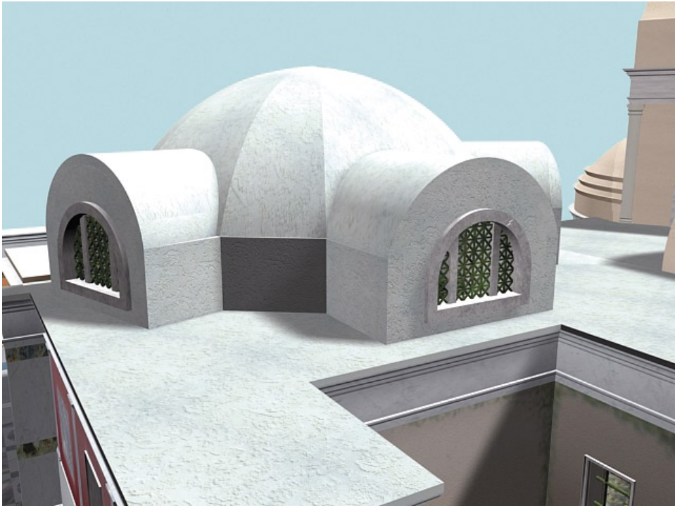
Fig. 15 – Volta a padiglioni del ninfeo. Da notare la copertura, immaginata piana, dell'ambiente n. 5 (se ne intravede la finestra in basso sulla destra) e delle latrine (solaio in primo piano).
