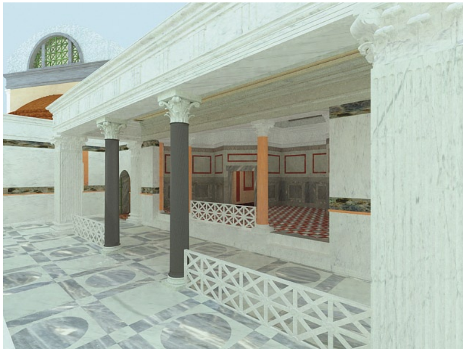
Fig. 13 – Facciata del ninfeo con le colonne tortili, le transenne, le colonne trasformate in pilastri e l'ingresso al podio. Sullo sfondo la porzione superiore e la volta della facciata orientale del frigidario.
