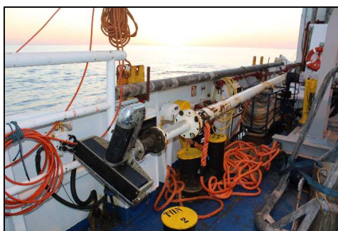
Figura 3 – Installazione a palo del Multibeam Echo Sounder SeaBat 7125
