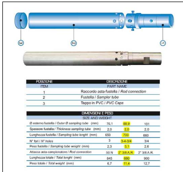
Figura 2 – Caratteristiche del campionatore semplice Shelby utilizzato.
