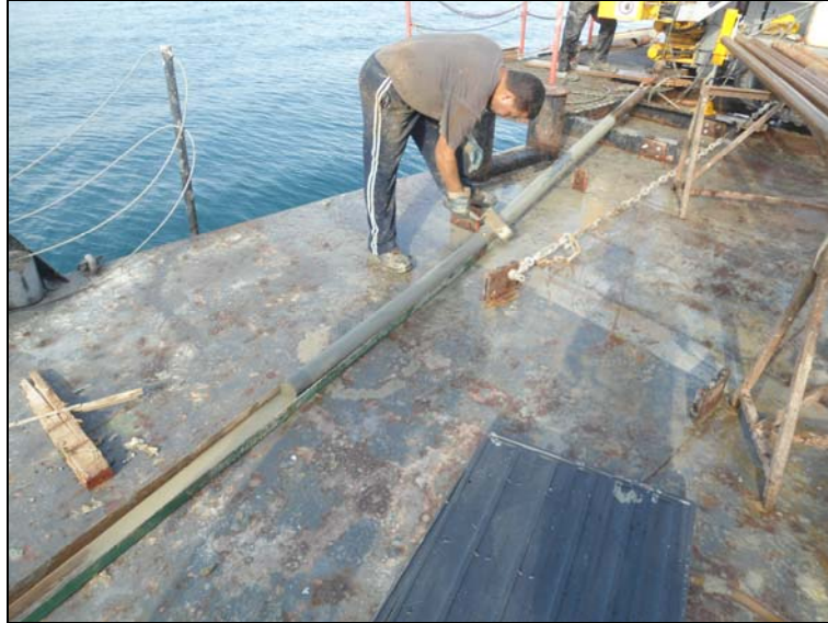
Foto 2 –Particolare Carotiere semplice T1 durante l'estrusione di una carota.
