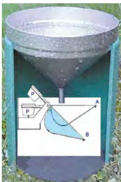
Figura 31 - PLUVIOMETRO A SINGOLA VASCHETTA OSCILLANTE.
