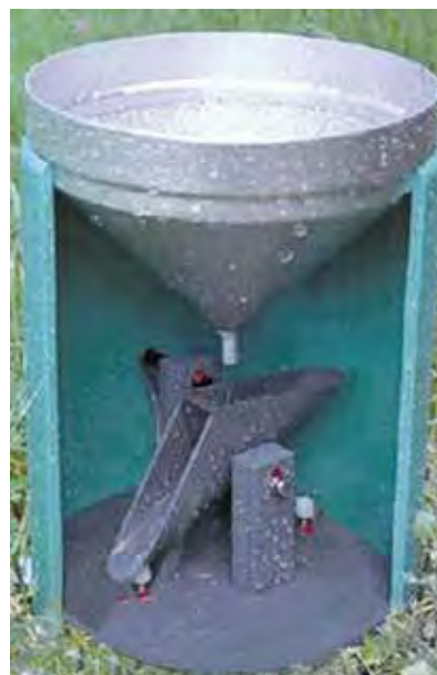
Figura 32 - "Spaccato" di un moderno PLUVIOMETRO A DOPPIA VASCHETTA OSCILLANTE.
