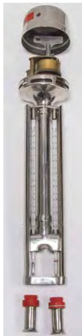
Figura 23 B – PSICROMETRO ASPIRATO MECCANICAMENTE di Assmann. In alto il coperchio è sfilato per mostrare gli ingranaggi e la chiavetta per caricare la molla. In basso sono sfilati i due cilindri che proteggono i bulbi termometrici, quello di destra, bulbo umido, è avvolto dalla garza bagnata. Lo strumento è ancora in uso. Foto di Gianni Fasano.
