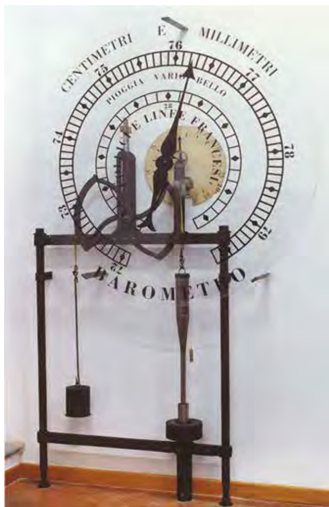
Figura 18 - GRANDE BAROMETRO PUBBLICO. Fu progettato da Filippo Cecchi in collaborazione con Giovanni Antonelli e costruito, a Firenze nel 1860, dal meccanico Niccolò Masini. Per volontà del Ministro nazionale dell'educazione, Cosimo Ridolfi, il barometro fu collocato nella Loggia dei Lanzi in Piazza della Signoria. Lo strumento è del tipo a bilancia: ciò che viene rilevato non è il livello del mercurio, ma il suo "peso". Infatti il tubo barometrico con un manicotto è appeso ad un bilanciere munito di contrappeso. Le variazioni di pressione influiscono sul livello del mercurio nel tubo e le conseguenti variazioni di peso modificano la posizione del bilanciere che è collegato meccanicamente a una lancetta indicatrice. Lo strumento, che era accompagnato da un grande termometro metallico (oggi scomparso), cessò di funzionare come barometro pubblico intorno al 1930. Il vano che conserva il meccanismo fu murato. Esso fu casualmente ritrovato nel 1993. Il quadrante in vetro è un rifacimento moderno. Lo strumento (dimensioni 117 cm x 232 cm) è attualmente esposto nella sala XI del Museo Galileo, Firenze. Riproduzione su concessione del Museo Galileo, Firenze.
