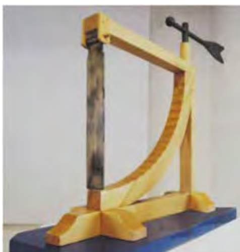
Figura 27 - MISURATORE A PALETTA DELL'INTENSITÀ DEL VENTO nella versione di Leonardo da Vinci A) Il modello riportato in figura, realizzato in legno, è una paletta che, sotto la spinta del vento, si sposta lungo un arco di cerchio graduato indicando l'intensità della velocità. A questa è associato un anemoscopio a banderuola per indicare la direzione del vento. Rielaborazione da [17]. B) Disegno originale, databile tra il 1483 e il 1486, tratto dal Codice Atlantico di Leonardo da Vinci, conservato nella Veneranda Biblioteca Ambrosiana di Milano. [18].
