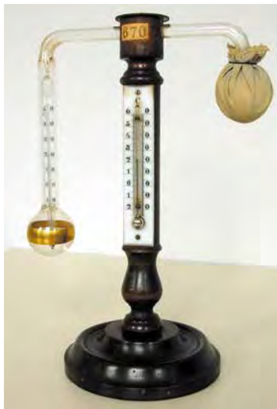
Figura 22 - IGROMETRO A PUNTO DI RUGIADA di Daniell.
