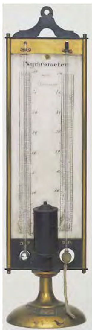
Figura 23 A – PSICROMETRO di August. A sinistra il termometro a bulbo asciutto a destra quello a bulbo bagnato . È ben visibile la garza, che con un estremo avvolge il bulbo termometrico mentre l'altro va inserito nel contenitore dell'acqua (al centro fra le scale termometriche) in modo da mantenere il bulbo sempre umido. Lo strumento (dimensioni 44 cm x 11,6 cm) è attualmente esposto alla sala XIV del Museo Galileo, Firenze, (costruttore sconosciuto). Riproduzione su concessione del Museo Galileo, Firenze – Archivio Fotografico
