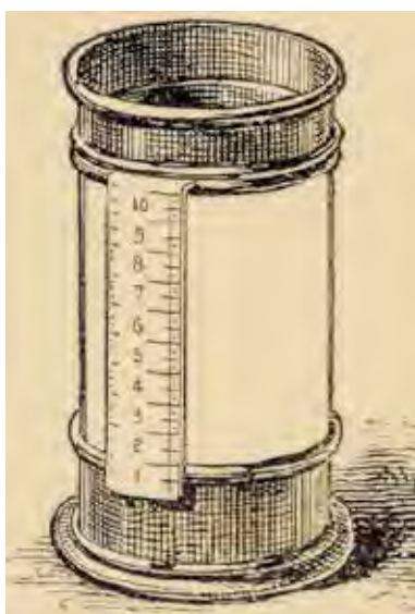
Figura 9 – Schema del PLUVIOMETRO TOTALIZZATORE di Benedetto Castelli (1639), da lui chiamato orinale . Rielaborazione da [15].
