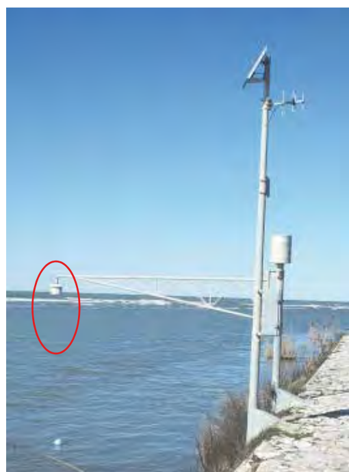
Figura 42 - Radar ultrasonico per misure di livello. A sinistra stazione meteorologica montana, nel cerchio il nivometro [22]. A destra stazione idrometeorologica, nel cerchio il misuratore di livello dell'acqua [23].
