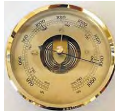
Figura 14 - In basso un moderno BAROMETRO A CAPSULA ANEROIDE (visibile al centro), collegata a una lancetta. In alto un barografo del 1930 in cui sono ben evidenziati il dispositivo aneroido, formato da più capsule, e il sistema di trasmissione dei movimenti collegato a un pennino scrivente. I due strumenti sono tutt'ora in uso. Foto di Gianni Fasano
