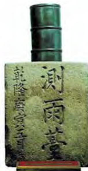
Figura 8 – PLUVIOMETRO COREANO [107]. L'uso dei pluviometri iniziò nel XV secolo, probabilmente come ausilio nella coltivazione del riso. A partire dal 1441, durante il regno di re Sejong, fu realizzata una rete di pluviometri che fu usata senza cambiamenti fino al 1907.
