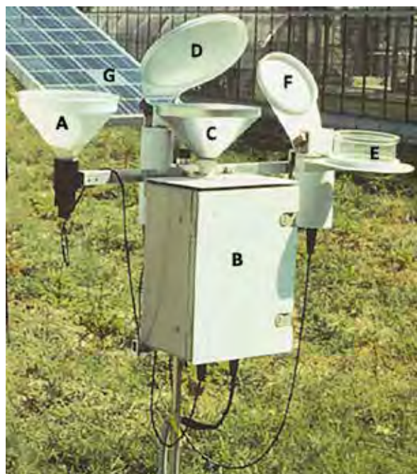
Figura 41 - IETO-PHMETRO ELETTRONICO (1994) con campionatore sequenziale di pioggia e di deposizioni secche. Realizzazione CNR-IBIMET. Un pluviostato optoelettronico si attiva all'inizio di un evento piovoso chiudendo il coperchio del contenitore della deposizione secca e contemporaneamente aprendo il coperchio dell'imbuto che convoglia l'acqua al pHmetro. Viceversa al termine dell'evento piovoso. Durante la pioggia lo strumento registra il valore del pH dei campioni di acqua sequenzialmente raccolti. A: pluviostato; B: contenitore del pHmetro e dell'elettronica di comando; C: imbuto convogliatore della pioggia; D: coperchio di C; E: raccogliitore deposizione secca; F: coperchio di E; G: pannello fotovoltaico. Foto di Gianni Fasano.
