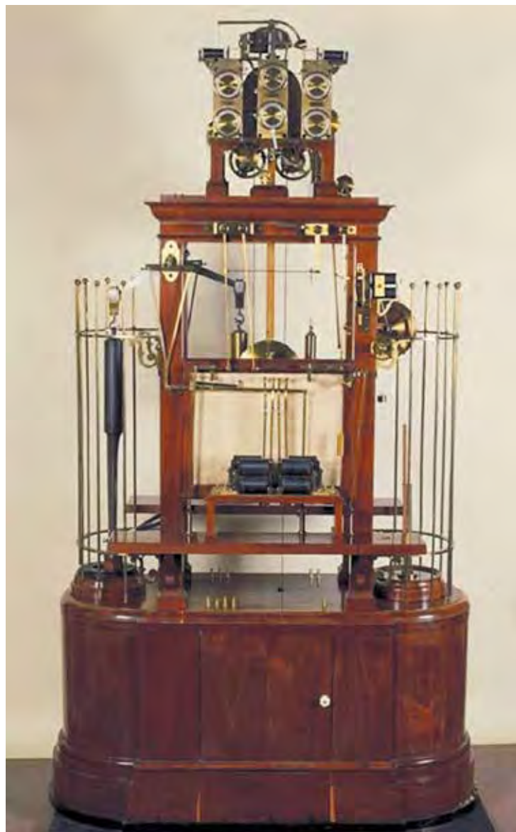
Figura 38 – Meteorografo dell'osservatorio astronomico del Collegio Romano di Padre Angelo Secchi (1867); strumento attualmente esposto al Museo Astronomico Copernicano di Monte Porzio Catone (Roma) (Riproduzione su concessione di ©INAF Museo Astronomico e Copernicano).
