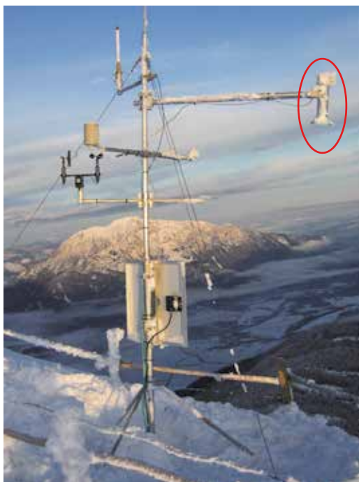
Figura 42 - Radar ultrasonico per misure di livello. A sinistra stazione meteorologica montana, nel cerchio il nivometro [22]. A destra stazione idrometeorologica, nel cerchio il misuratore di livello dell'acqua [23].
