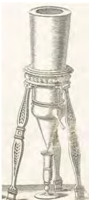
Figura 21 - IGROSCOPIO A RUGIADA di Ferdinando II de' Medici.
