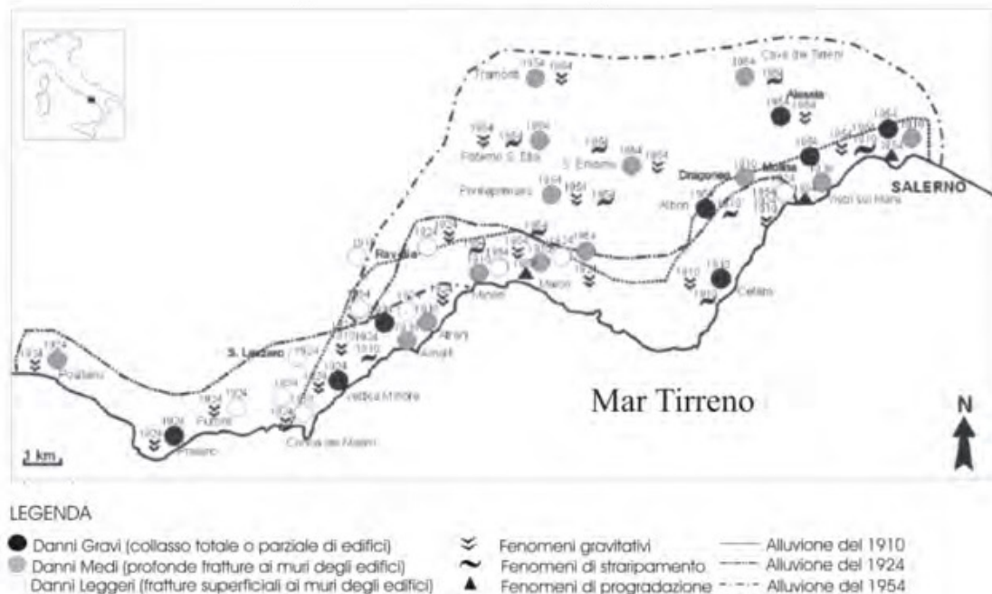
Figura 20 - Sintesi grafica della distribuzione dei principali eventi alluvionali, livello di danneggiamento e distribuzione dei fenomeni geologici indotti dalle alluvioni del 1910, 1924 e 1954 nelle principali località della Costa d'Amalfi. Da Esposito et al. 2003.
