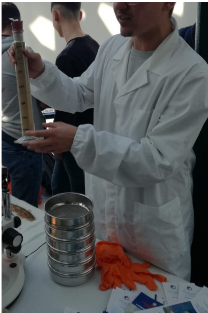
Figura 101: Uno studente del Liceo Ruggieri di Marsala, all' exhibit di Esperienza InSegna 2020, intento nel mostrare una colonna all'interno della quale è stata separata la sabbia in base alla diversa granulometria, descrivendo il lavoro svolto durante il "Laboratorio di Analisi granulometriche" in occasione del PCTO presso l'IAS – CNR S. S. di Capo Granitola.
