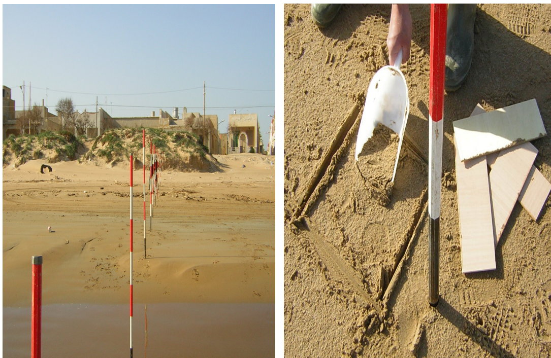
Figura 27: Esempio di transetto e prelievo di campione della spiaggia emersa.
