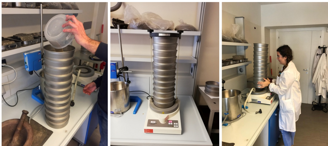
Figura 68: Pila di setacci, vibrovaglio e setacciatura del campione
