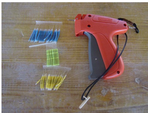
Figura 6.25 – Particolare della pistola e delle etichette impiegate per la marcatura delle aragoste.
