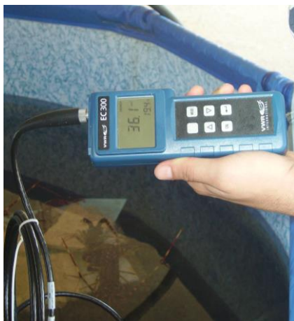
Figura 6.22 – Sonda multiparametrica impiegata per il monitoraggio dei parametri chimico/fisici delle vasche di stabulazione.
