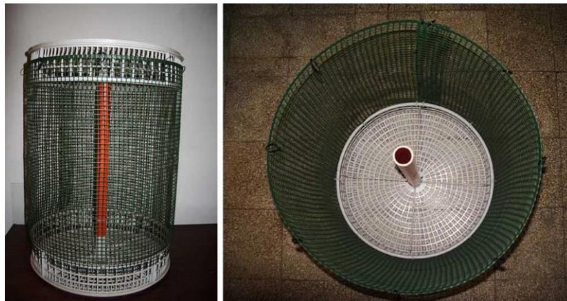
Figura 6.13 – Gabbie con capacità di 70 litri realizzate per il trasporto e rilascio delle aragoste.
