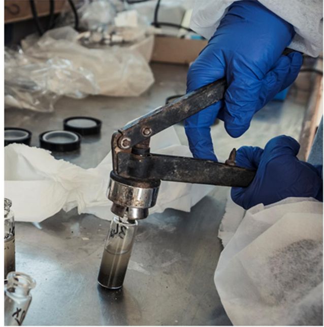
Fig. n3 e n4 Fase di campionamento puntuale con vials da sportello superiore della benna Van veen.
