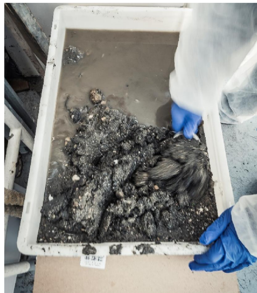
Fig. n2 Omogeneizzazione del sedimento.
