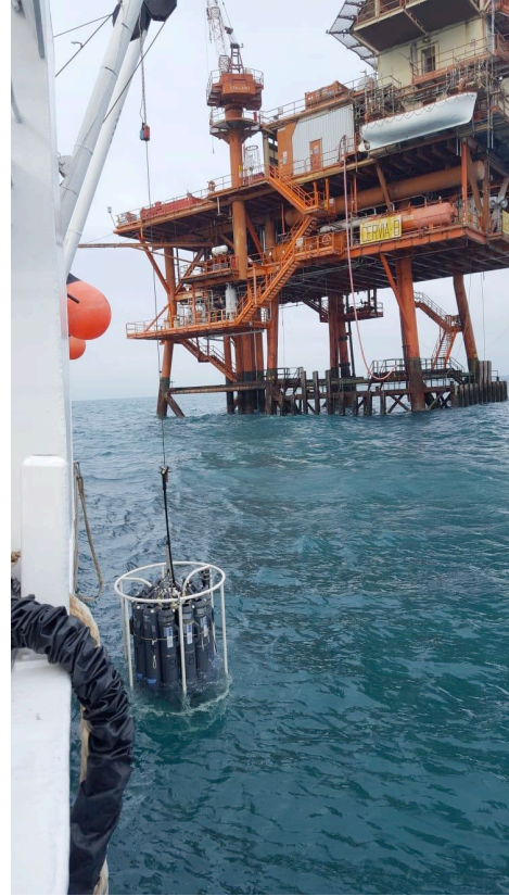
Figura 5: Campionamento sedimenti con box-corer (a sinistra); acquisizione profili idrologici con sonda multiparametrica CTD e campionamento acqua con bottiglie Niskin (a destra)
