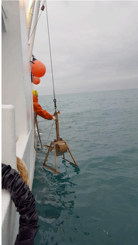
Figura 5: Campionamento sedimenti con box-corer (a sinistra); acquisizione profili idrologici con sonda multiparametrica CTD e campionamento acqua con bottiglie Niskin (a destra)
