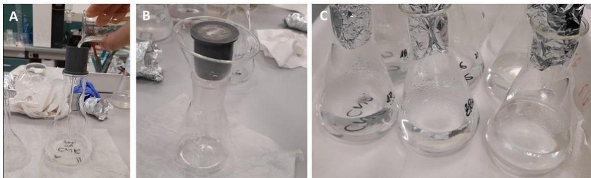
Figura 5: Fasi della filtrazione su membrana  $100\ \mu\text{m}$
