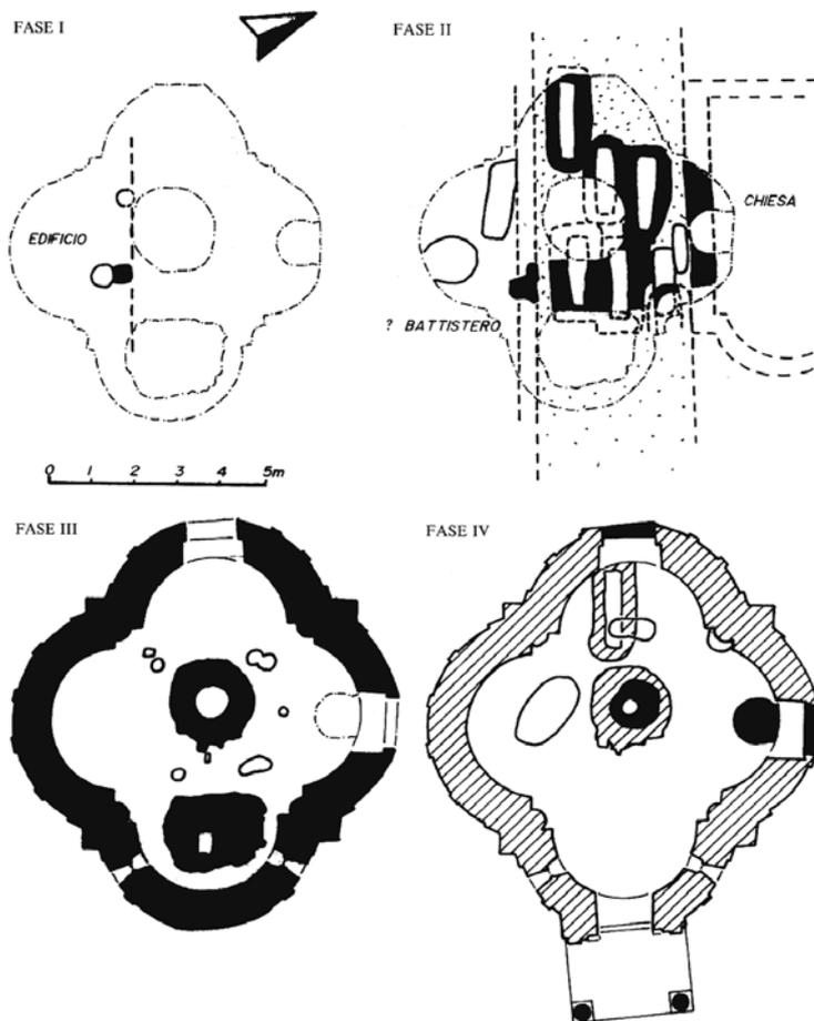
Fig. 1. Planimetrie delle fasi costruttive del battistero.
