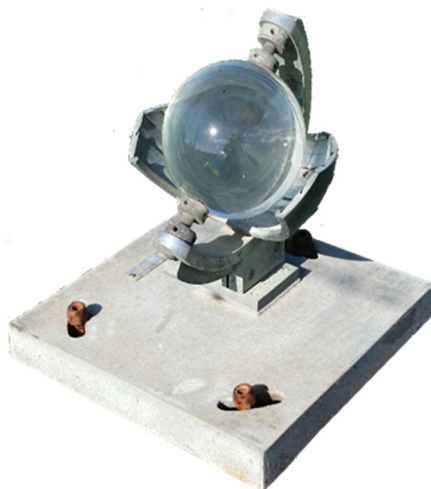
Figura 5.14 B – Elioanografo di Campbell-Stokes (Foto di Gianni Fasano): a sinistra la sfera con il supporto per la carta diagrammatica; sotto, la carta diagrammatica per le diverse stagioni, a partire dall'alto: inverno, primavera autunno, estate.
