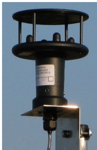
Figura 6.2 – Anemometro a ultrasuoni. Foto di Gianni Fasano.
