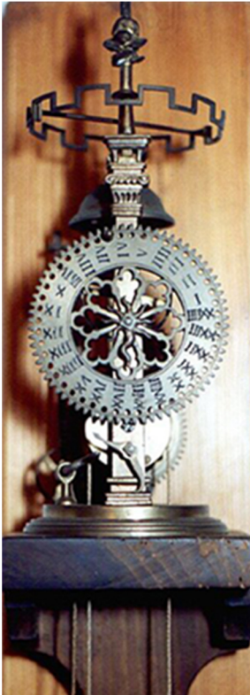
Figura 1.4 – Svegliatore (o svegliarino) monastico, riproduzione di orologio del secolo XV con bilanciere circolare (Realizzazione in metallo di Pieraugusto Grisoli - 1992, Pozzaglio - Cremona, Collezione privata) [16].
