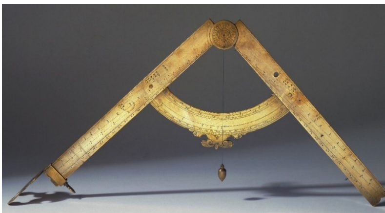
Figura 5.49 – Compasso geografico militare; Riproduzione su concessione del Museo Galileo, Firenze, Archivio Fotografico.
