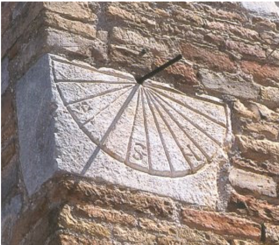
Figura 1.3 – Gnomone di meridiana su parete verticale. L'ombra indica l'ora del dì (Chiesa di Santa Maria a Piè di Chienti 1125, Macerata.)
