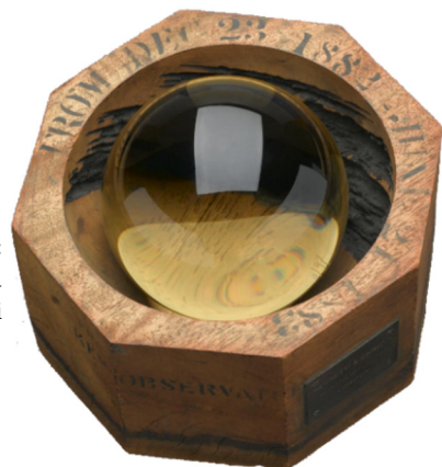
Figura 5.14 A – Eliofanografo di John F. Campbell: la lente sferica è alloggiata nel contenitore, sulla parete interna del quale sono visibili le tracce di bruciatura prodotte dalla radiazione solare. Science Museum Group. Campbell type sunshine recorder, used at Kew Obser. Science Museum Group Collection Online. [1003].
