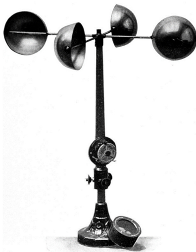
Figura 5.34 – Anemometro a quattro coppe di Thomas Robinson [1008].
