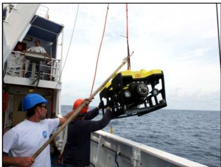
Figura 8. ROV Pollux III in dotazione alla N/O Urania del CNR al momento del calo in acqua
