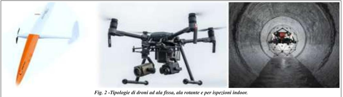
Fig. 2 -Tipologie di droni ad ala fissa, ala rotante e per ispezioni indoor.
