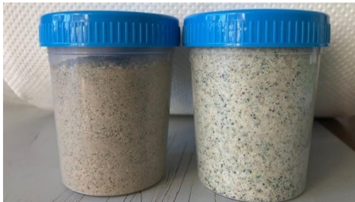
Figura 7: Polveri ottenute dalla macinazione criogenica con maglia da 1 mm.
