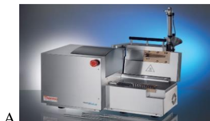
Figura 8: A) Estrusore da banco minilab HAAKE® in dotazione presso i laboratori dell'IPCB-CNR. B) carica del materiale macinato e opportunamente additivato; c) materiale in uscita dal processo di estrusione
