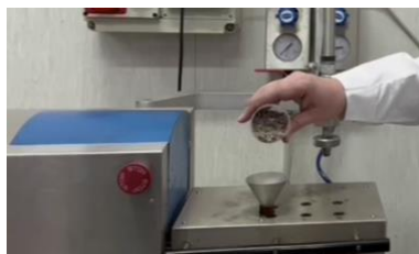
Figura 8: A) Estrusore da banco minilab HAAKE® in dotazione presso i laboratori dell'IPCB-CNR. B) carica del materiale macinato e opportunamente additivato; c) materiale in uscita dal processo di estrusione
