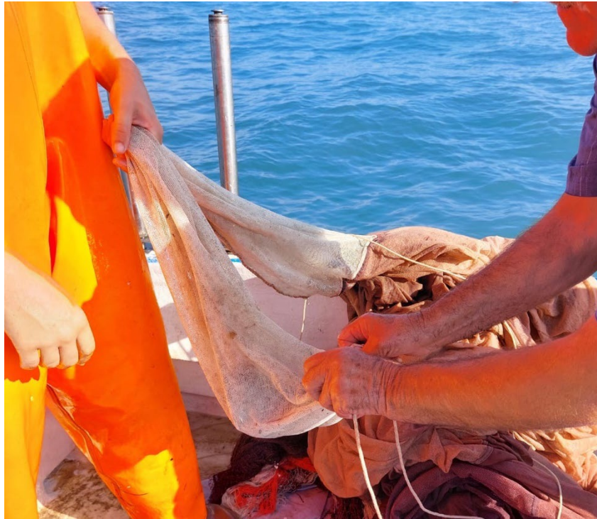
Figura 2.19 - Particolare del sacco della retina a circuizione utilizzata dalla 00MZ01554 in cui si vede il sacco, definito "velo" con maglia da 2 mm di lato.
