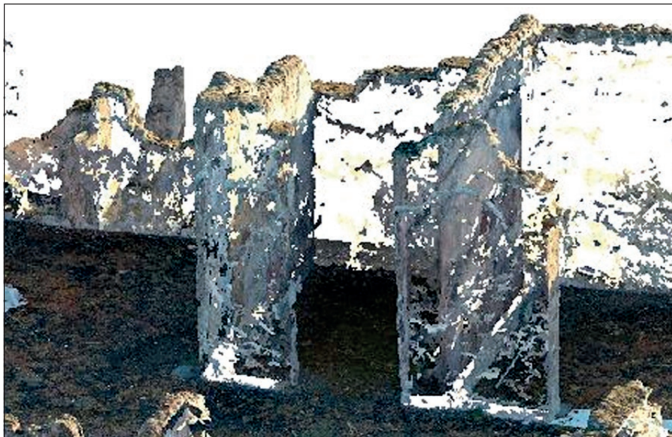
Fig. 8 – Nuvola fotogrammetrica ottenuta dalle immagini nadirali, e pertanto carente nell'elevato, da integrare mediante fotogrammetria terrestre e/o laser scanner per una visione d'insieme completa (elaborazione E. Berrino).
