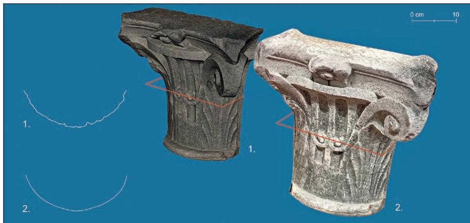
Fig. 4 – Comparazione dei modelli ottenuti con i diversi sistemi di scansione: 1) a luce strutturata; 2) LiDAR (di Apple).
