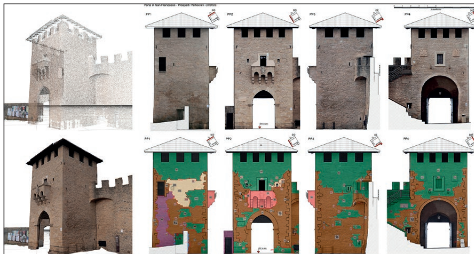
Fig. 6 – Tavola sinottica di Porta San Francesco. A sinistra dall'alto: nuvola di punti e modello 3D con texture fotografica. A destra: ortofoto dei singoli prospetti a confronto e mappatura del palinsesto stratigrafico e delle fasi edilizie (DHILab - CNR ISPC).
