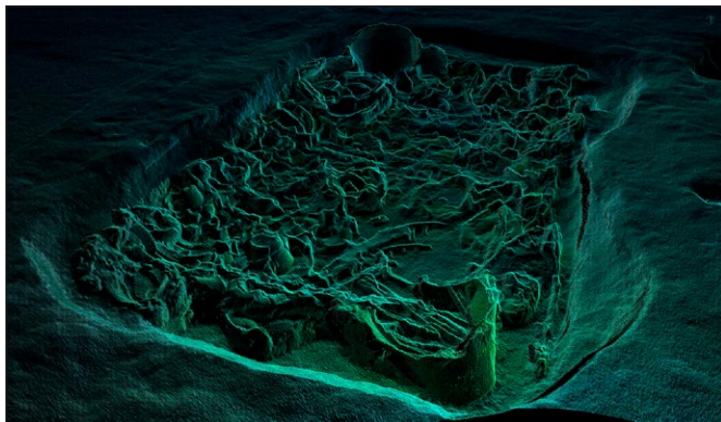
Fig. 5 – Esempio di nuvola di punti della fossa-deposito generata dal rilievo laser scanner.
