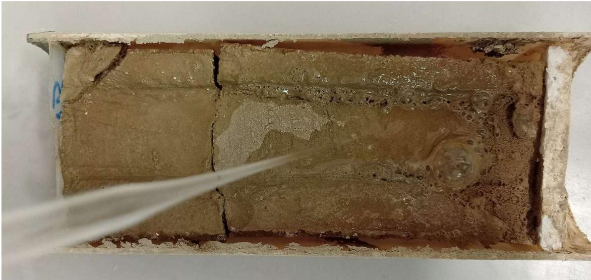
Prima della misura di confronto del campione ossidato, lo stesso è stato nuovamente portato ad essiccazione in forno a temperatura mai superiore a 40°C.
