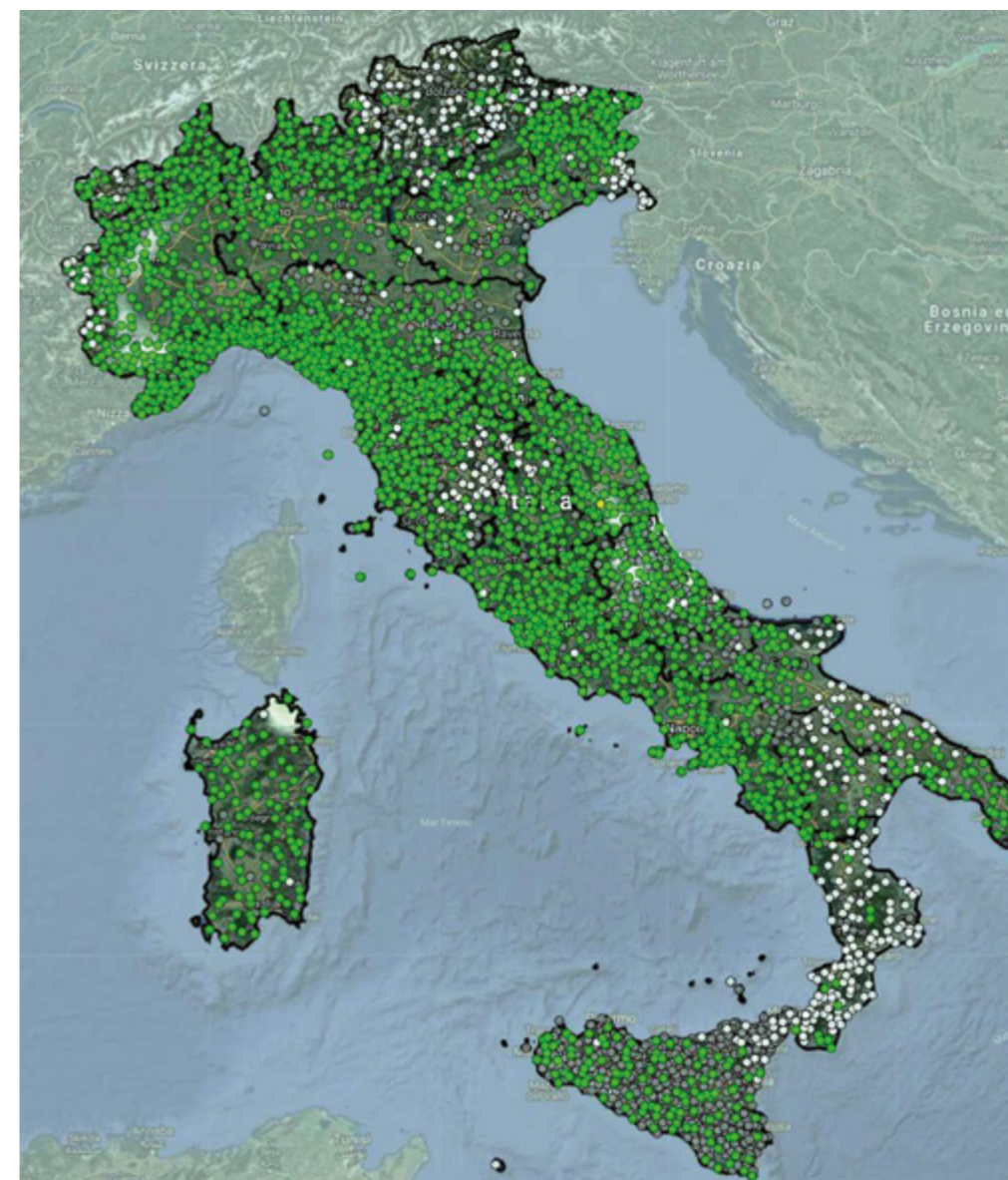
Figura 3.7 Stazioni idro-meteo-pluviometriche in telemisura della Rete dei centri funzionali del DPC. Immagine tratta dalla piattaforma Dewetra.
