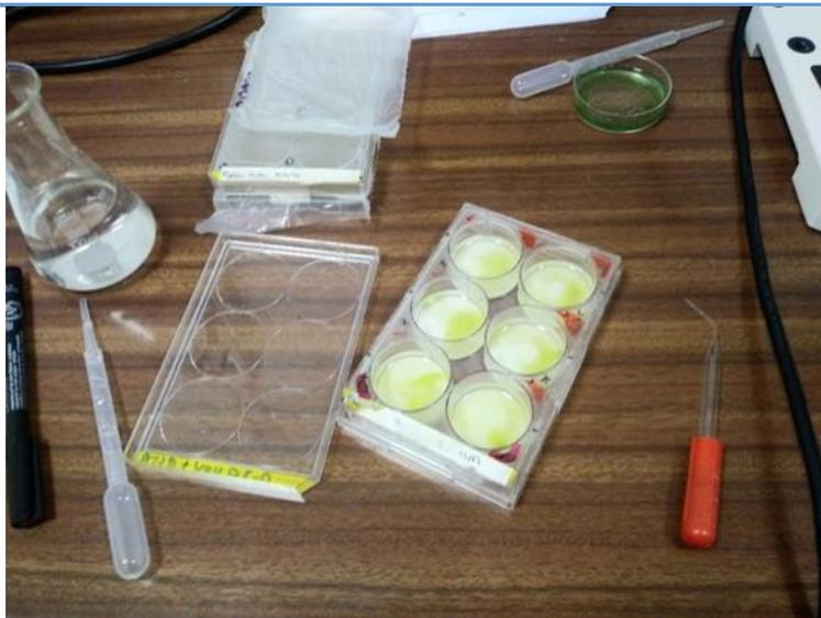
**Figura 3.** Allestimento del test con polvere di caolino: si nota come, dopo 12 ore di decantazione, il substrato risulta ben decantato e il medium del test non mostra torbidità evidente
