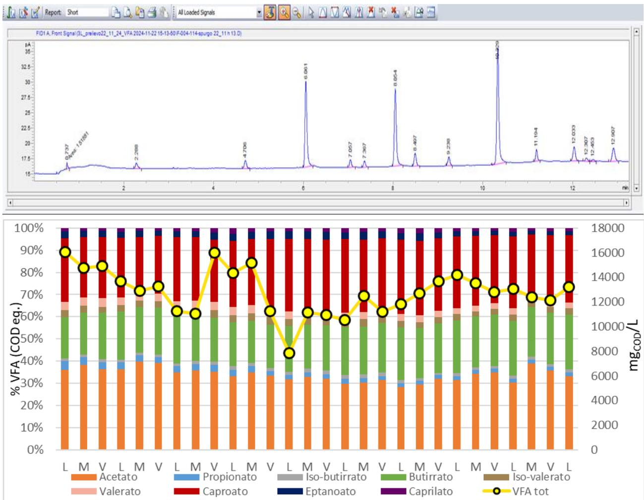
**Figura 2.** Cromatogramma di un campione di digestato per quantificare i VFA tramite GC Agilent 8860 (in alto) e distribuzione percentuale degli stessi durante la prova (in basso)
