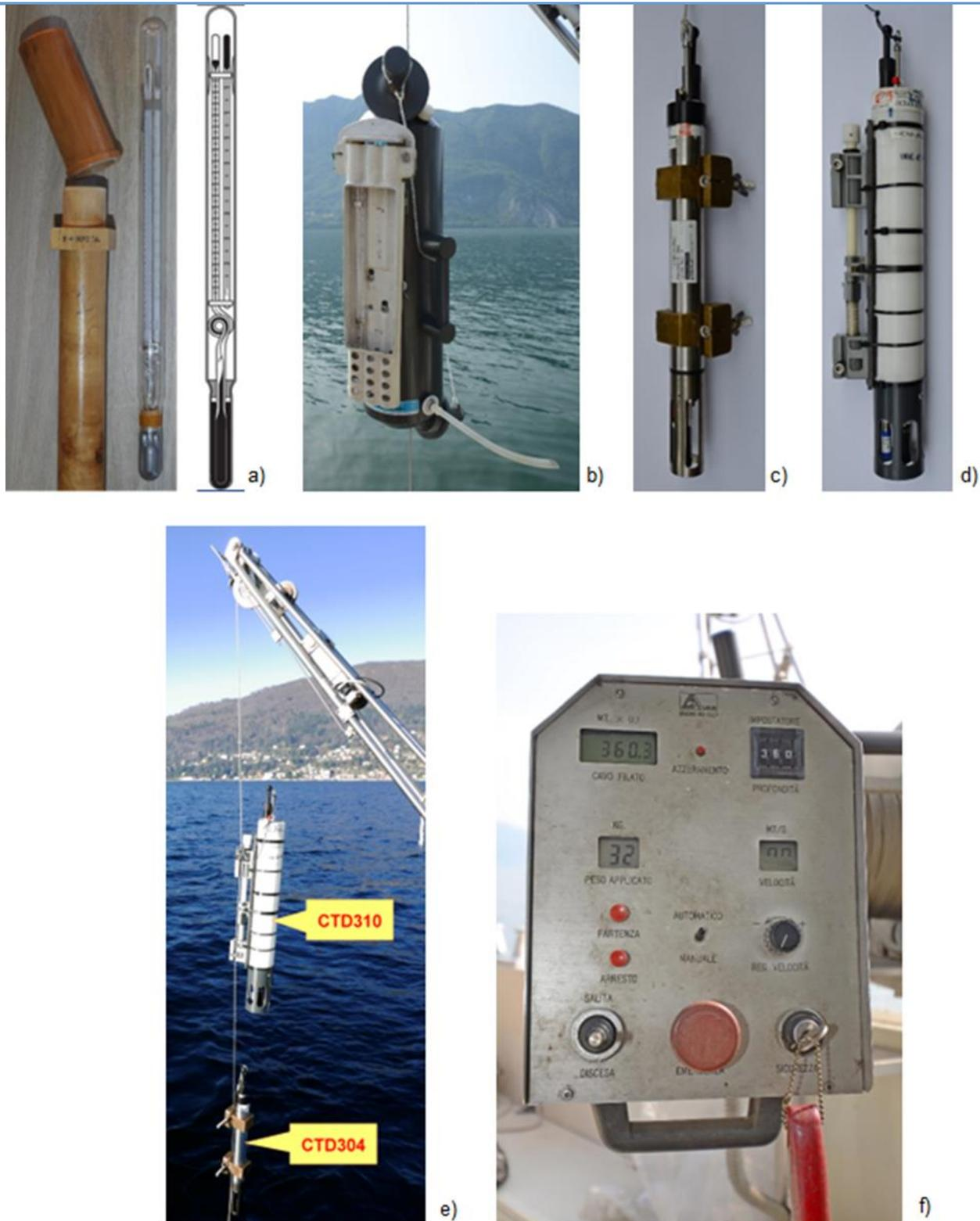
**Figura 1.** Misura della temperatura delle acque del Lago Maggiore: a) Termometro a rovesciamento con custodia in legno; b) Termometro a rovesciamento montato sulla bottiglia Niskin di campionamento; c) Sonda multiparametrica Idronaut CTD 304 Plus; d) Sonda multiparametrica Idronaut CTD 310; e) Campionamento con sonde Idronaut CTD 304 e 310; f) Contametri per il controllo del cavo di campionamento
