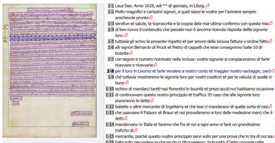
Fig. 3 – Esempio di abbinamento tra le linee tracciate nell'immagine di una lettera dell'Archivio Saminati-Pazzi e la trascrizione del testo nel backend di Transkribus.
