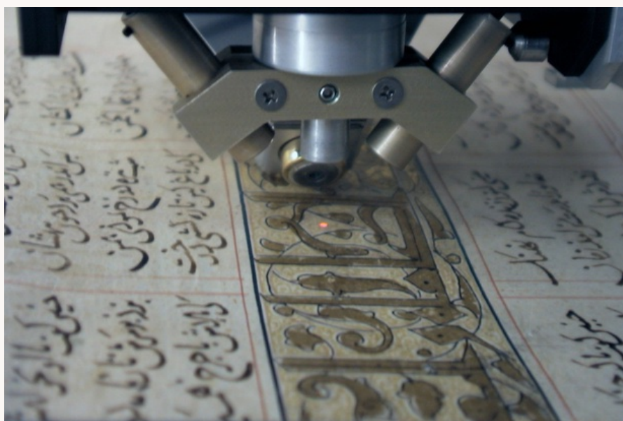
XRF sullo Shāh-Nāme di Firdusi in collaborazione con il Cr.Forma, Centro Formazione Professionale di Cremona. © Alessandro Sidoti
