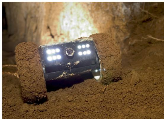
Fig. 1a. Robot filo guidato con doppia telecamera e trazione motrice sulle 4 ruote.
