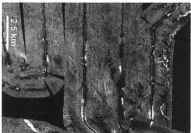
Fig. 7. Side Scan Sonar (TOBI) image showing the rugged seafloor morphology of the Ischia debris avalanche. See Fig. 6 for location. Sonogramma Side Scan Sonar (TOBI) illustrante la morfologia accidentata del fondo marino nell'area dei debris avalanche di Ischia. Vedi Fig. 6 per l'ubicazione di questa immagine.
