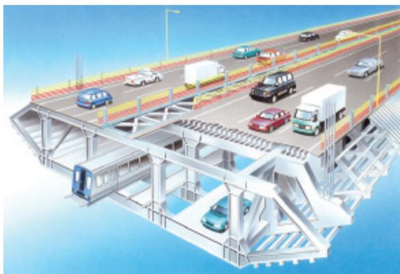
Fig. 3 - Vista assonometrica dell'impalcato
