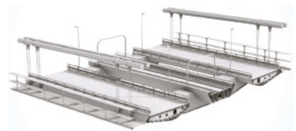
Fig. 22 - Vista assometrica dell'impalcato e del sistema di sospensione
