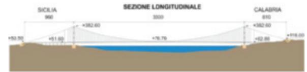
Fig. 20 - Sezione longitudinale del ponte
