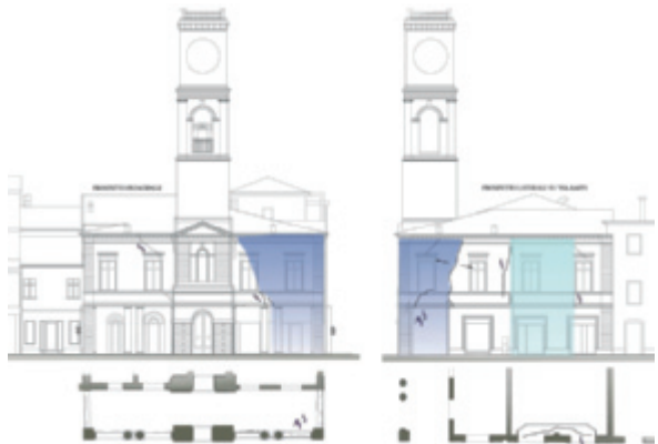
Fig. 4a - Interpretazione del quadro fessurativo sul fronte principale e su quello laterale lungo la via Saffi.
