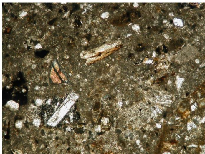
Fig. 40. Sezione sottile di una malta dalla stanza 47 (100X) N+.
