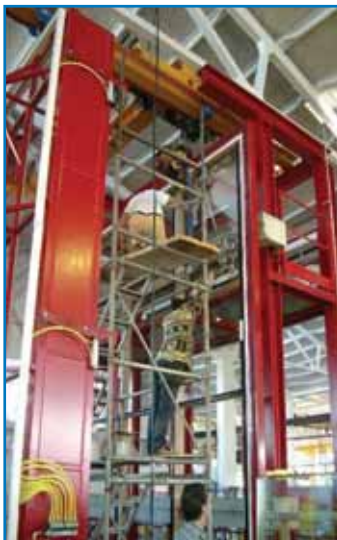
Fig. 3: Apparecchiatura per la ricerca ed il controllo delle prestazioni di facciate esterne (aria, acqua e carico del vento).
