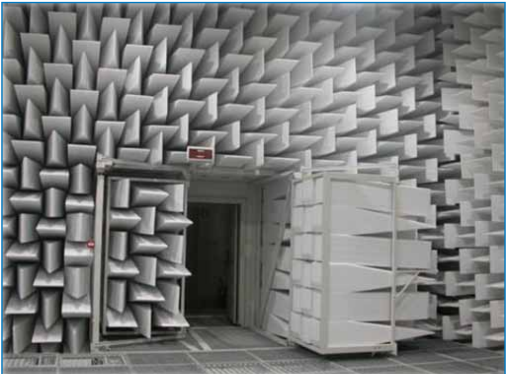
Fig. 6: Camera Anecoica presso il Dipartimento di Ingegneria dell'Università di Ferrara
