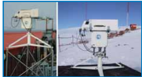
Fig. 8: Spettrofotometri Brewer MKIV nei siti polari di Ny Ålesund (79° N, sx) e Belgrano (79° S, dx)
