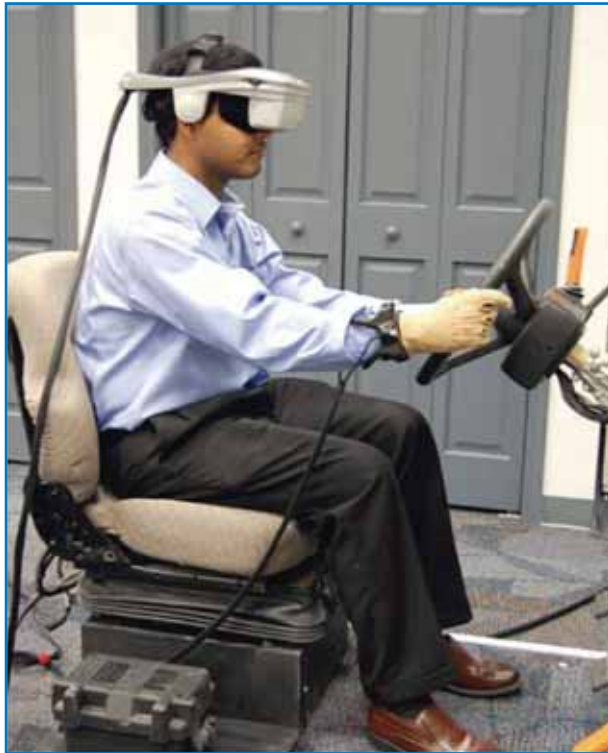
Fig. 8: Il sistema di realtà virtuale per l'operatore (Fonte: New Holland Construction Equipment)
