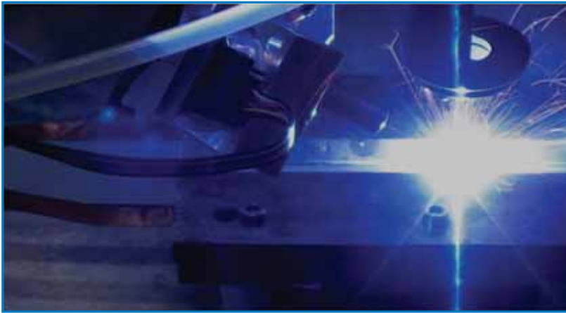
Figura 6. Testa del sensore optoelettronico multi-spettrale per il monitoraggio della saldatura laser di lamiere metalliche nella produzione automotive.
