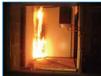
Fig. 4: Single Burning Item (SBI): Apparecchiatura per la verifica della reazione al fuoco di prodotti da costruzione secondo le metodologie obbligatorie europee
