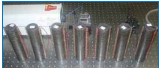
Figura 4: Banco prova per sensori e harvester piezoceramici e piezoelettrici e stack di attuatori piezoceramici in test
