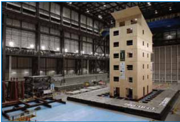
Figura 6. Test sismico eseguito in Giappone su edificio di sette piani
