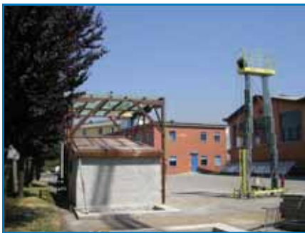
Figura 7. Allestimento in scala reale ad hoc per la caratterizzazione acustica (isolamento di facciata e rumore da pioggia battente) di falde per tetti
