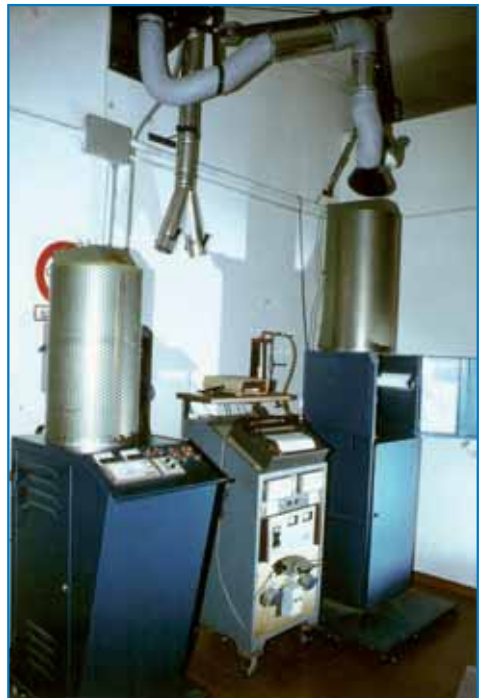
Fig. 5A: Forni di tipo Bridgman verticali , costruiti al MASPEC per la crescita di cristalli di PbTe e PbSnTe
