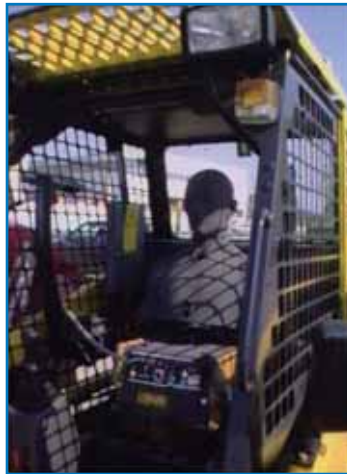
Fig. 10: Tecnica binaurale: registrazioni dei due segnali sonori al posto operatore con l'ausilio di una testa artificiale
