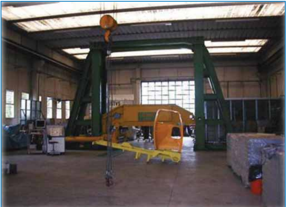
Fig. 5: Macchina di carico biassiale per prove ROPS presso la sede di Ferrara
