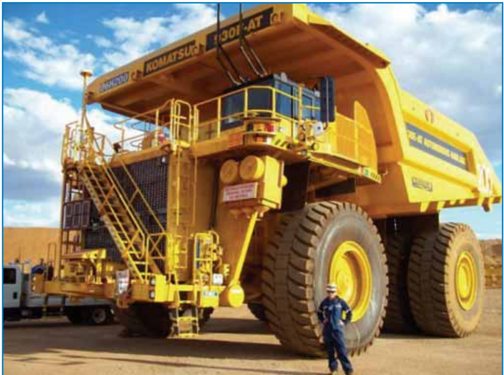
Fig. 11: Komatsu 930E-AT, dumper articolato da miniera a guida autonoma (con possibilità di operatore a bordo...sempre che ne abbia il tempo).
