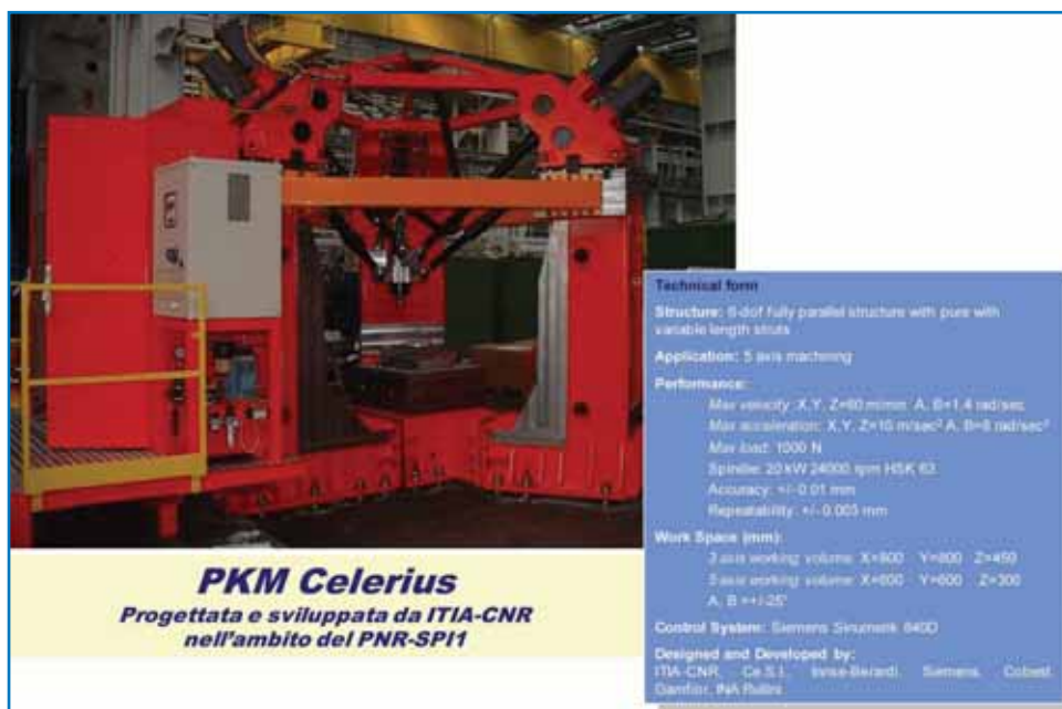
Fig. 6: Macchina a cinematica parallela PKM Celerius progettata e sviluppata da ITIA nell'ambito del progetto PNR-SPI 1
