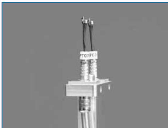
Fig. 15: Sonda iper-intensimetrica per la misura del tempo di riverberazione
