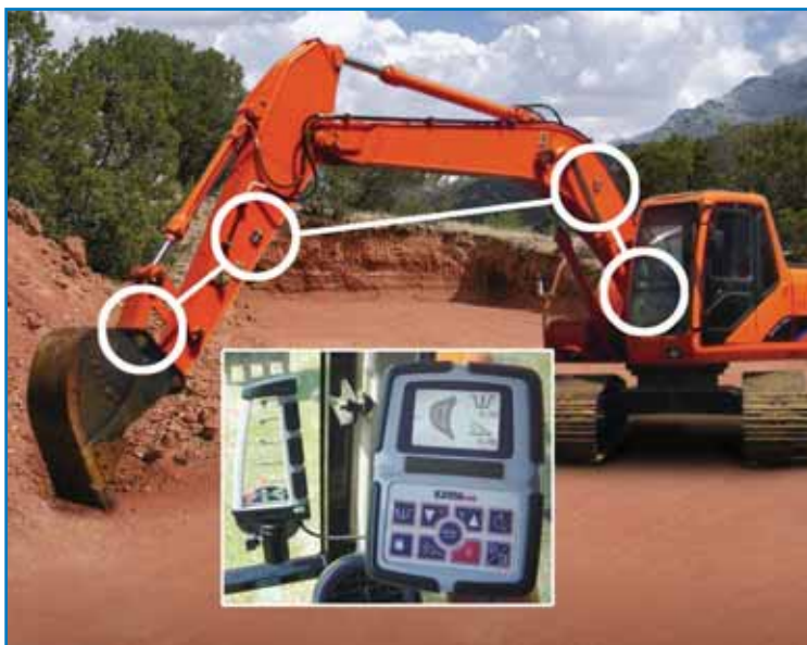
Fig. 9: Sensorizzazione per il controllo di scavo di un escavatore
