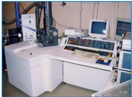
D) Sistema combinato di Catodoluminescenza raffreddata all'Elio liquido, EBIC ed Elettroluminescenza per indagini ottiche alla nanoscala ed elettriche al Microscopio Elettronico a Scansione
