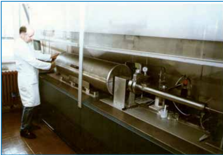
Fig. 6: Reattore epitassiale, realizzato al MASPEC per la deposizione da fase vapore (metodo degli idruri) di film di strutture a base di GaAs e InP
