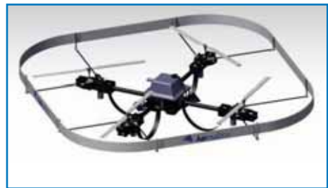
Figura 3: Droni Quadricotteri per monitoraggio delle colture e invio di dati in real time
