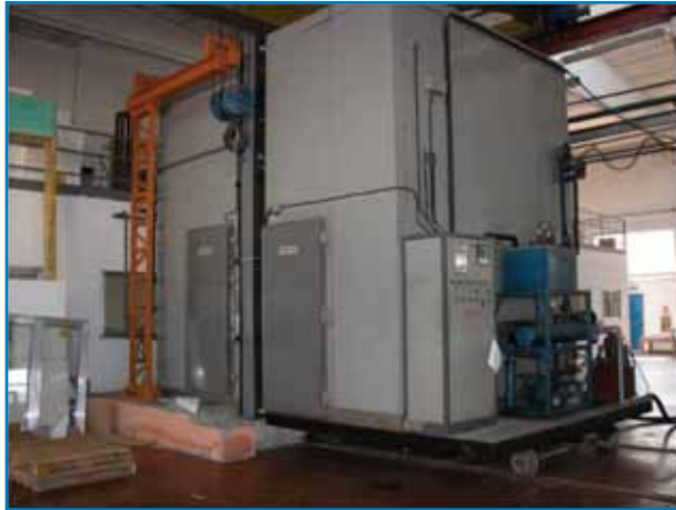
Fig.2: Hot box: Camera termica con anello di guardia per la misura della trasmittanza termica.
