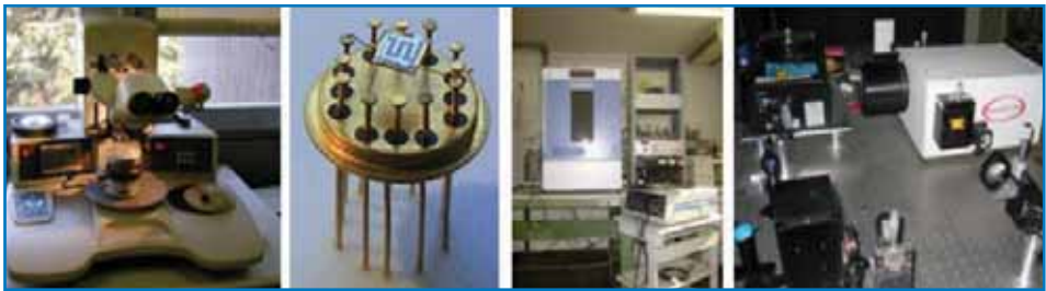
Fig. 11: Microsaldatrice, case con sensore, camera di test per sensori chemoresistivi e set up per sensori di gas ottici.
