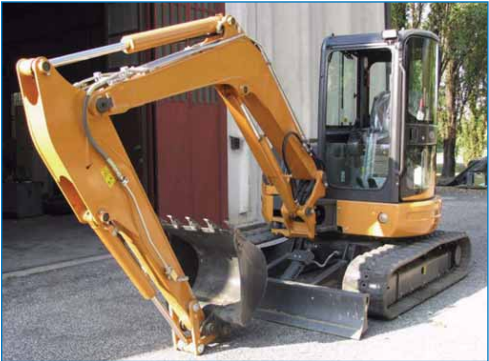
Fig. 17: Escavatore idraulico strumentato per prove di consumo
