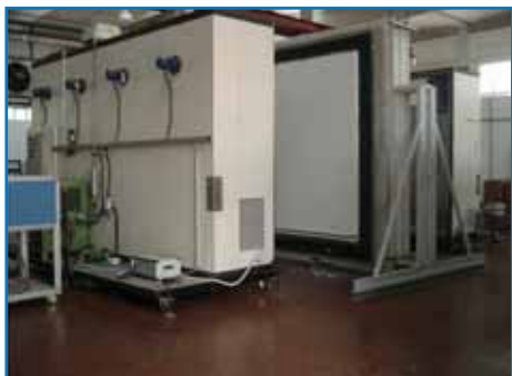
Fig. 6: Apparecchiatura per sperimentazioni in laboratorio in assemblaggio reale di ETICS (External Thermal Insulation Composite Systems with Rendering).
