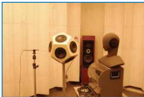
Fig. 6: Strumentazione per prove di ascolto e misure di suono in camera trattata.
