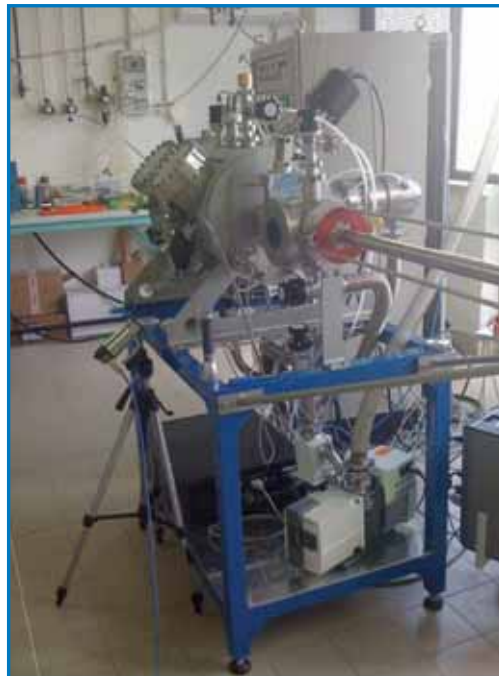
Figura 3: Macchina sperimentale per la deposizione di film di CIGS mediante PED
