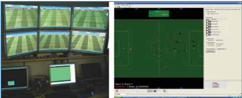
Sinistra: Console del prototipo OFFSIDE installato nello stadio Friuli di Udine; Destra: vista virtuale dell'intero campo di gioco nel quale sono proiettate le posizioni dei giocatori e tracciato il loro movimento e quello del pallone.
