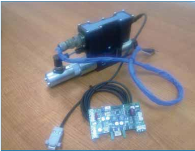
Fig. 11: Prototipo di valvola ed elettronica di controllo "fast switching"
