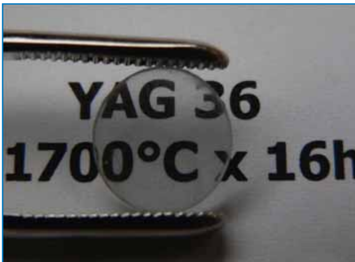
Figura 12. Materiale ceramico policristallino trasparente a base di YAG (alluminato di ittrio).
