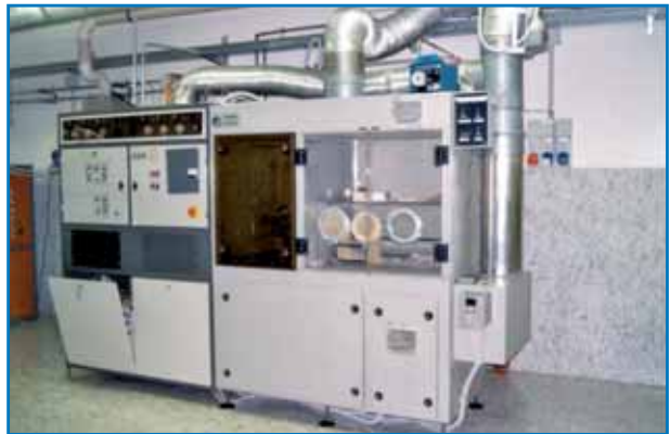
Fig. 18: Uno dei quattro reattori, operativi in IMEM, per la deposizione di film da CVD
