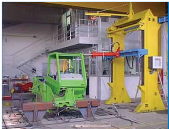
Fig. 8: Attrezzature per prove ROPS su macchine agricole presso Candiolo
