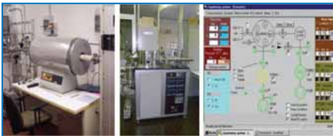
Fig. 9: Impianti automatizzati per la produzione di materiali nanostrutturati presso SENSOR. Forno tubolare per la crescita di nanocristalli; impianto di magnetron sputtering; maschera di controllo di processo.
