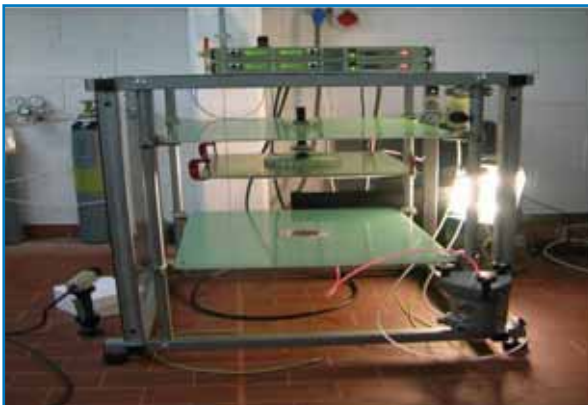
Figura 9. Sistema di elettrofilatura multijet per la deposizione in continuo di nanofibre su substrati tessili in scala pre-industriale.
