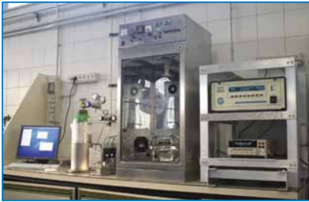
Figura 4. Sistema sperimentale integrato per la misura del disinquinamento fotocatalitico dell'aria. Da sinistra si può vedere il sistema computerizzato di controllo, il generatore dell'aria con la bombola di inquinanti in tracce, la camera di irradiazione con il reattore fotocatalitico (aperta per esposizione) ed il sistema analitico dell'aria in uscita.
