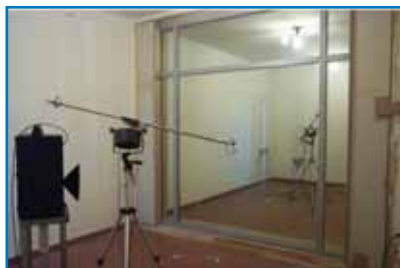
Fig. 5: Camera per la verifica del potere fonoisolante
