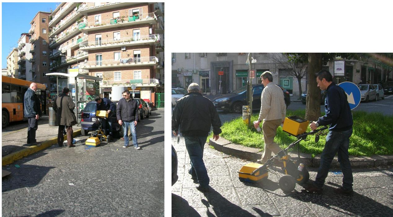
Figura 14: Fase di acquisizione dei dati GPR
