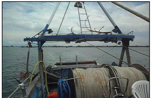
**Figura 8.** Fase dell'acquisizione. Una volta calata in mare la prima ancora, il peschereccio, filando in mare il cavo d'acciaio, si muove verso il secondo punto dello stendimento per calare la seconda ancora.
