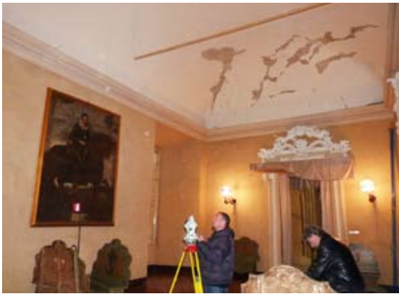
Fig. 12 Casi studio: B - Imola: rilievi con stazione globale
