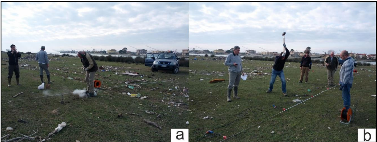
Figura 4. Fase di energizzazione a) mediante la sorgente sismica a cannoncino modello Minibang ; b) mazza battente.
