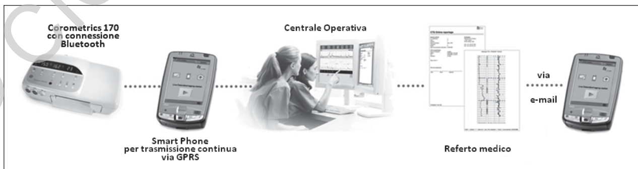
Fig. 3 - La nuova organizzazione del sistema TOCOMAT con tecnologia wireless .
