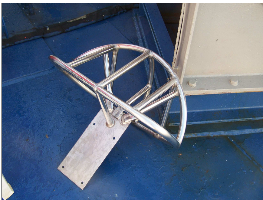
Fig. 1 - Gabbia di protezione per i trasduttori del Multibeam Reson Seabat 7111
