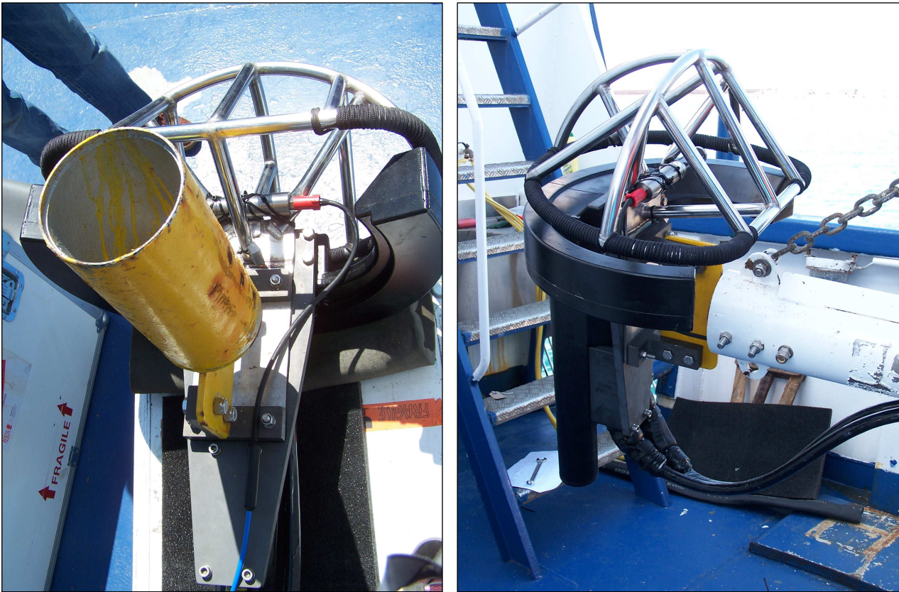
Fig.7 – A sinistra vista dall'alto del multibeam installato prima di montarlo sul palo e a destra il multibeam montato sul palo
