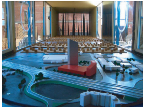
Fig. 2 - Inserimento del modello in galleria del vento.
