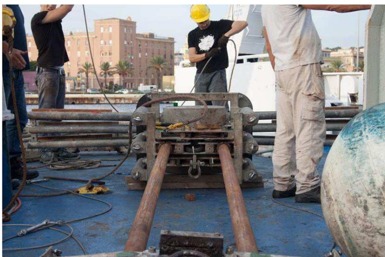
**Figura 1 - montaggio del Vibrocarotiere.**
