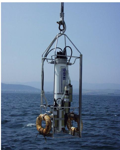
**Figura 8 - Sonda multiparametrica CTD.**
