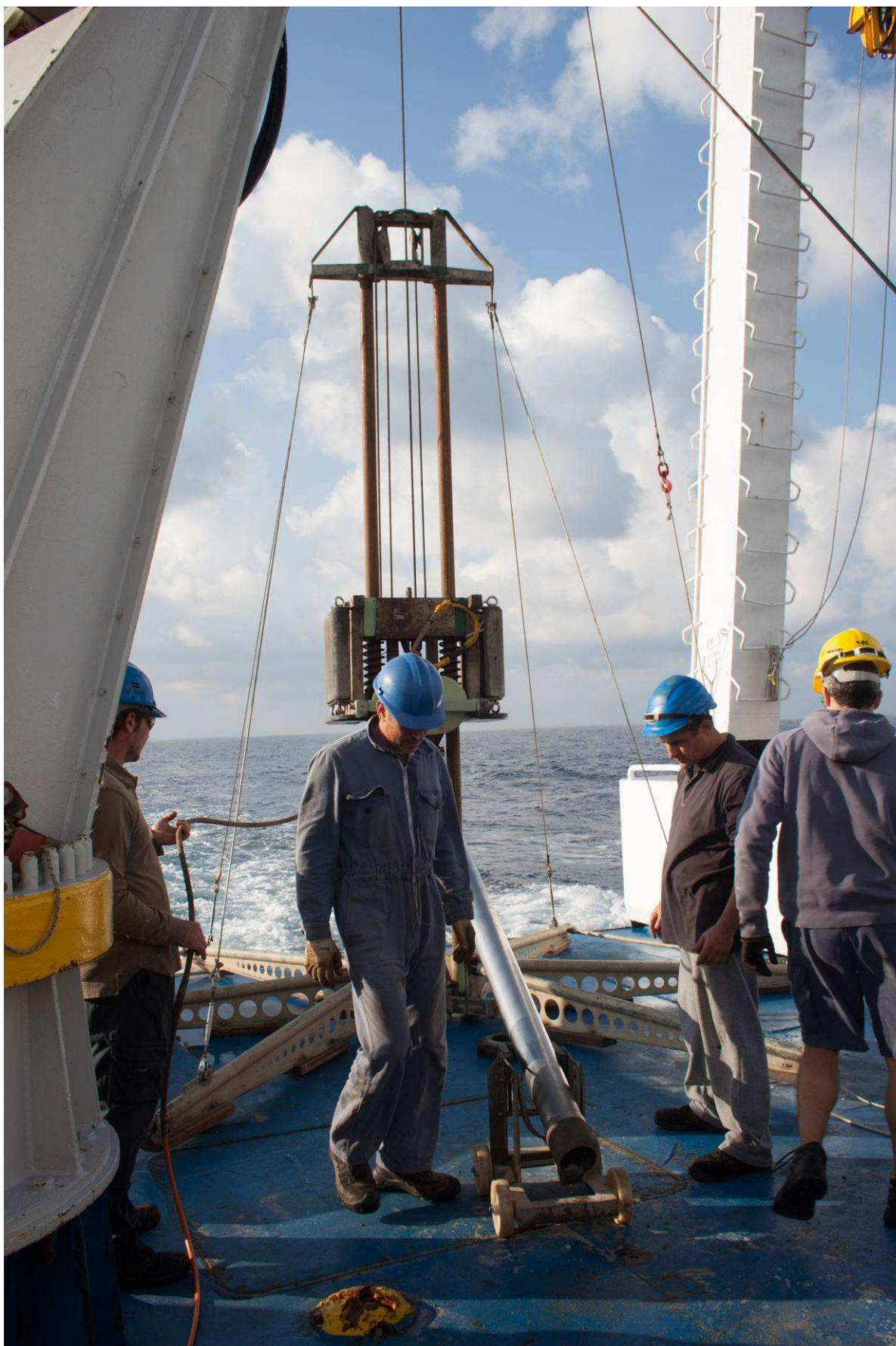
**Figura 4 - Fase di estrazione de liner.**
