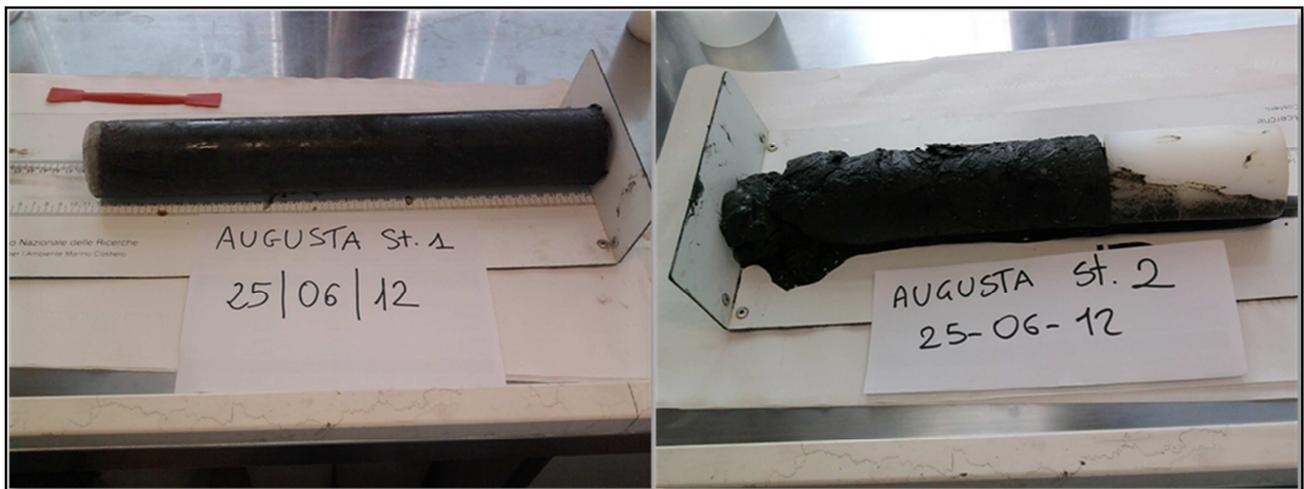
**Fig. 22** Carote di sedimento scongelate ed estruse per il sub campionamento.
