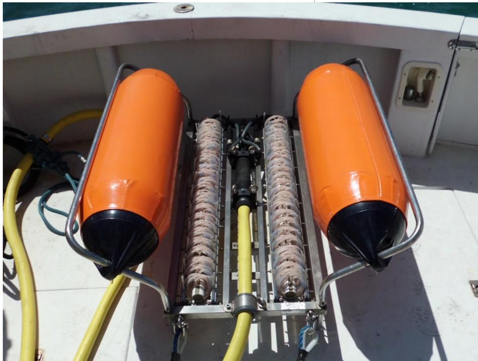
**Figura 9. Catamarano del sistema geo-spark contenente la sorgente**
