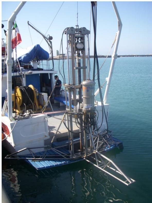
**Figura 31. Vibrocarotiere subacqueo “VGP 30/3”**
