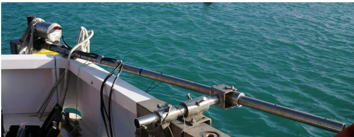
**Figura 11. Sistema di ancoraggio all'imbarcazione del multibeam Reson Seabat 8125**
