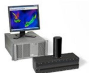
Lo strumento ha una frequenza operativa di 455kHz; il fascio emesso ha un'apertura angolare totale di 120° nella direzione perpendicolare alla nave, così da rilevare una fascia di fondale pari a circa 3,5 volte la profondità media; la risoluzione verticale massima è di 6 mm.
