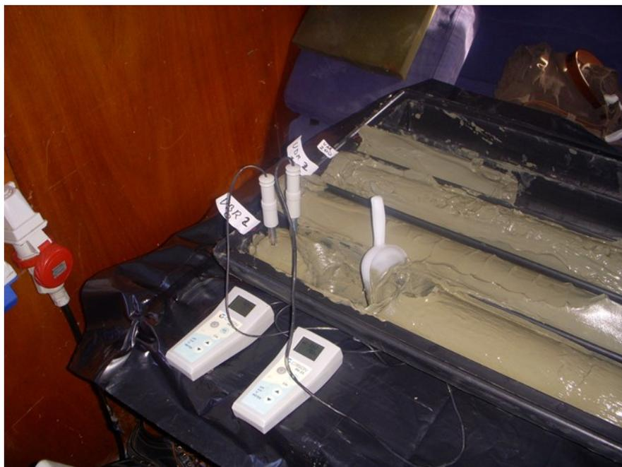
**Figura 33. Sonde per la misura di pH, Eh e Temperatura (°C)**
