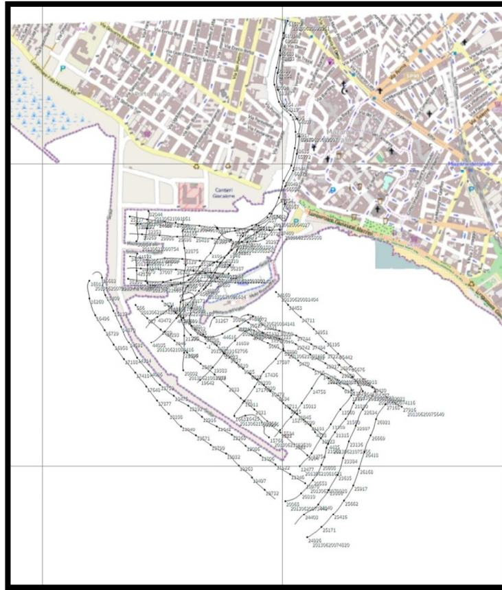
Figura 19 - Navigazione completa Subbottom Profiler Chirp
