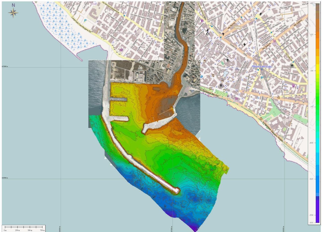
Figura 16 - Contour batimetrico. Da notare l'integrazione sulla batimetria dei dati singlebeam nel settore antistante il molo Buonvento.
