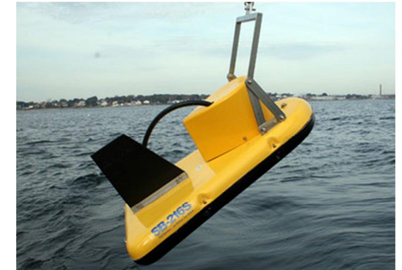
Rilievi geofisici del Porto di Mazara del Vallo effettuati nel mese di giugno 2013 con subbottom profiler Chirp Edgetech 3100 mod 216
