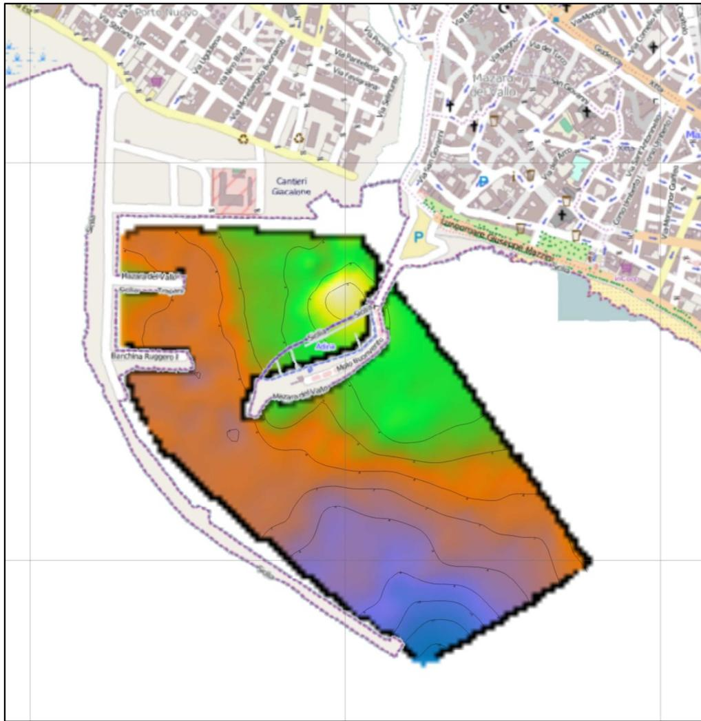
Figura 21 - Superficie acusticamente sorda (in bianco lo spessore di sedimento incoerente è inferiore al metro, in blu superiore ai dodici metri)
