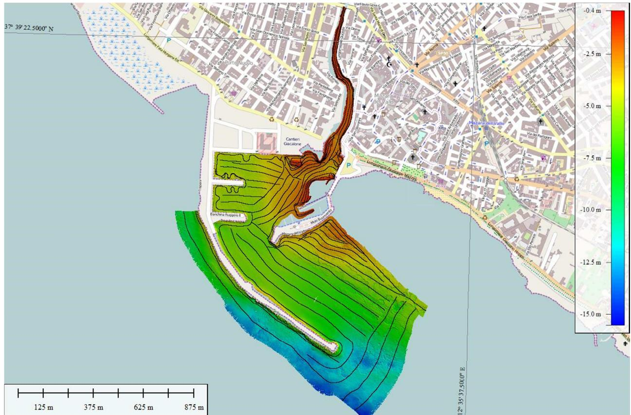
Figura 11 – Area totale acquisita con il Reson Seabat 7125 (dati grezzi).
