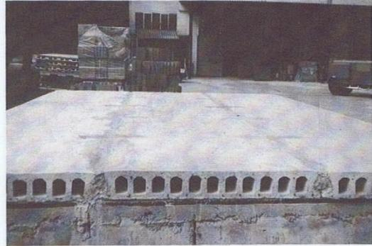
Foto 10 Solai assemblati. Si noti il getto delle tasche di collegamento
