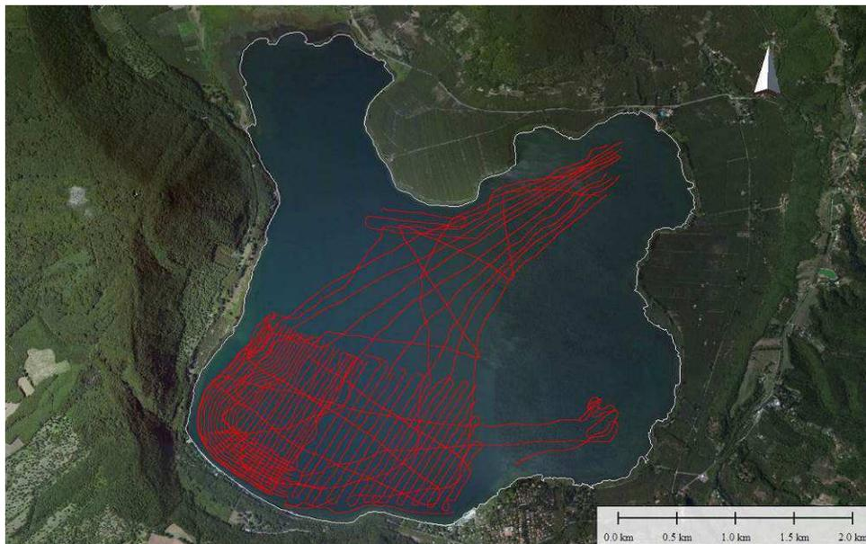
**Figure 16 – Navigazione dell'acquisizione magnetometrica.**
