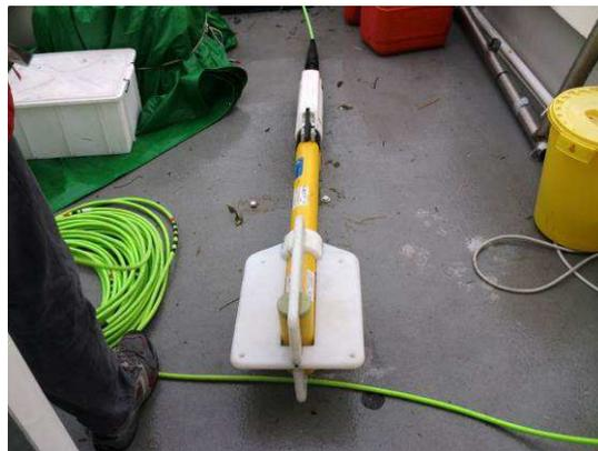
Figure 14 – Magnetometro utilizzato e trainato a poppa dell'imbarcazione
